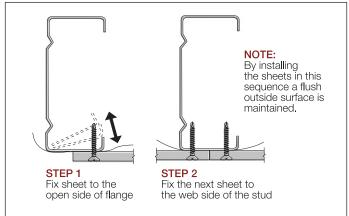
FIGURE 3 SCREW FASTENING
