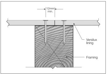
FIGURE 14 BUTT JOINTING DETAIL
