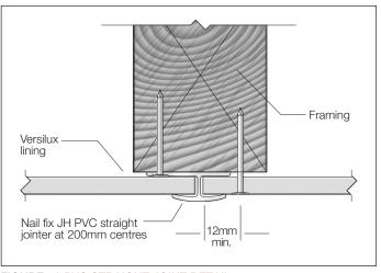
FIGURE 12 PVC STRAIGHT JOINT DETAIL
