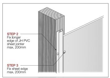
FIGURE 10 STEP 2 - FIX JOINTER
